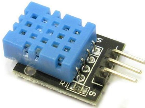
**Figure no 9:** DHT 11 sensor
