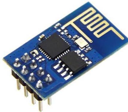
**Figure no 8:** ESP8266 Wi-Fi module
