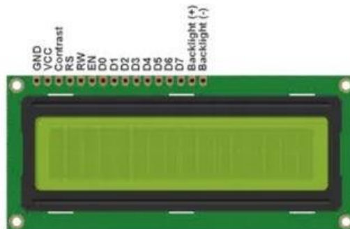
Fig.3. 16x2 LCD display
