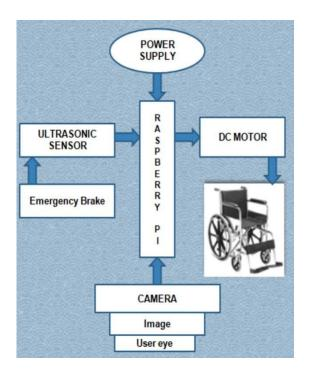
Fig. 1. Block Diagram
