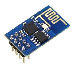
Figure no 8: ESP8266 Wi-Fi module
