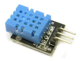
Figure no 9: DHT 11 sensor
